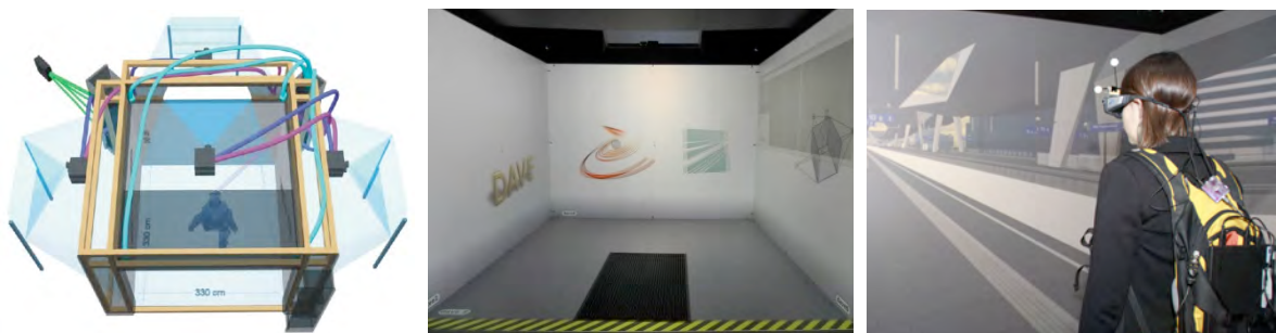
Abbildung 1. Immersive virtuelle Umgebung DAVE und Eye-Tracking System
